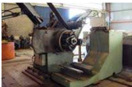
Perfiladora de vigas
